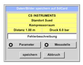
Anschließend ist es möglich die Parameter zu prüfen (Distanz und Druck) und die Messstelle mit Firma, Gebäude und Ort genau zu definieren. Zusätzlich ist es möglich eine kurze Fehlerbeschrei-bung (max. 32 Zeichen) einzugeben.
