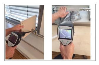
Überlagerung von Leckagen: Sollten Leckagen räumlich nah beieinander sein, überlagert sich der emittierte Ultraschall. Hier wird empfohlen, die Leckagen mit einem "Tuch abzudichten". Speziell bei der Quantifizierung der Leckage erhöht dies die Genauigkeit der Messung enorm. Gleichzeitig sollte hier räumlich sehr nahe an den Komponenten gemessen werden.
