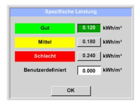
Die spezifische Leistung beschreibt die Effizienz des Kompressor-Systems. Wie viel elektrische Energie (kWh) wird benötigt um 1 Kubikmeter Druckluft (m³) zu erzeugen. Für diese sind 3 vordefinierte Anlagenwerte angelegt, sowie ein benutzerdefiniertes Eingabefeld für die individuelle Eingabe.
