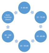
Mit der Einstelltaste "Empfindlichkeit" kann manuell zwischen den einzelnen Stufen gewechselt werden oder es wird die Auto Funktion zur Anpassung des Pegels gewählt. Die Reihenfolge ist in dem Schaubild links dargestellt.
