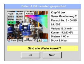
Im dargestellten Bild sind alle relevanten Daten der Leckage aufgeführt und können vor dem Abspeichern nochmals final überprüft werden. Alle Leckagen inklusive gemachter Eingaben werden ins Journal-File abgespeichert.
