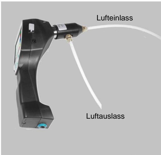
Kunststoff-Granulattrockner arbeiten in der Regel mit einem leichten Überdruck im millibar Bereich. Verwenden Sie bei dieser Anwendung mit leichtem Überdruck die Messkammer für Granulattrockner (Artikel Nr. 0699.3490).
