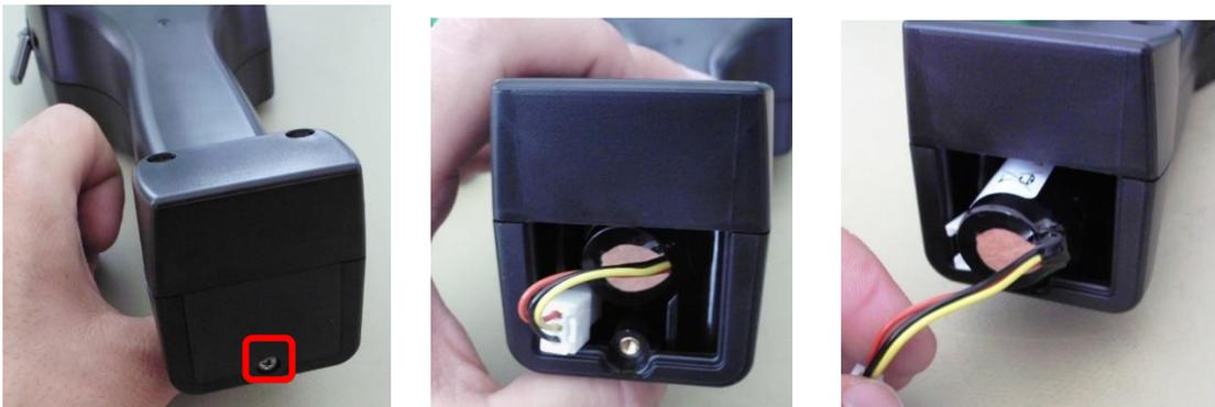
*Entfernen der Akku-Abdeckung Trennen der Steckverbindung Vorsichtig den Akku herausziehen*
