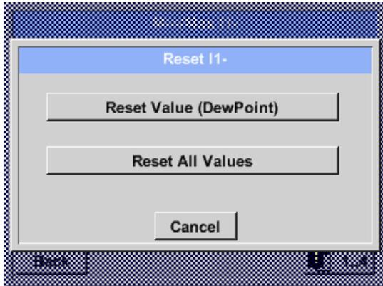
Es ist möglich einen einzelnen Messwert, hier z.B. der Drucktaupunkt oder wenn benötigt alle *Min- und Max*-Werte des Sensors zurückzustellen.
